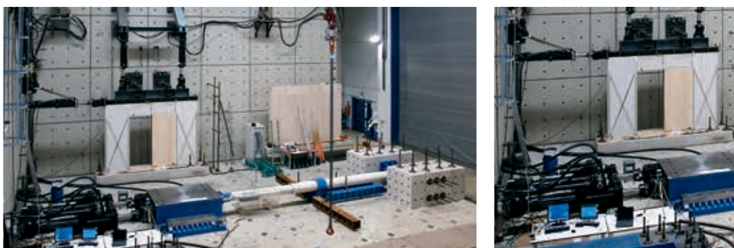
EUCENTRE, TREES Lab, sistema di prova per smorzatori
