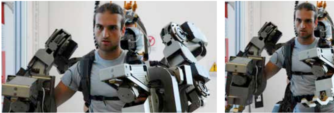
Il body extender realizzato dai ricercatori di Robotica Percettiva dell'Istituto TeCIP.
